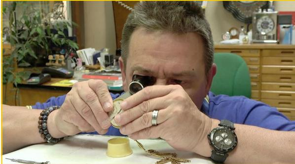
passionné par son métier, il n'en fallait pas plus pour qu'à deux ils en fassent le portrait. Nous le saisissons en plein travail : démontage, nettoyage et remontage d'un mécanisme de montre. Le domaine de l'infiniment petit, exigeant dans la précision et dans la mémorisation de la position
